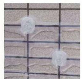
密封力が向上し目地とタイルの接合部に樹脂の移動が確認されず。
