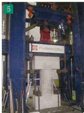
せん断破壊試験状況
