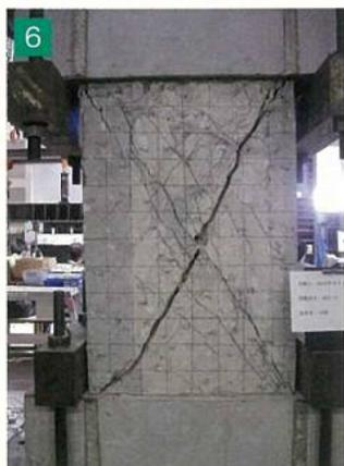
せん断破壊試験後状況
