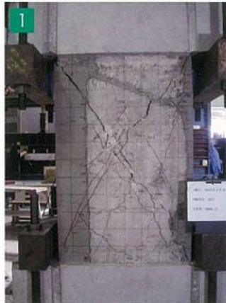
せん断破壊試験後補修前状況
