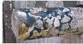
高密度に注入充填されたコンクリートブラックライトにより注入された樹脂が確認できます。
